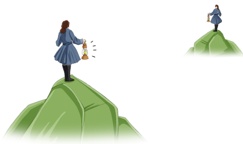
图 8-3 伽利略设想的光速测量示意图
