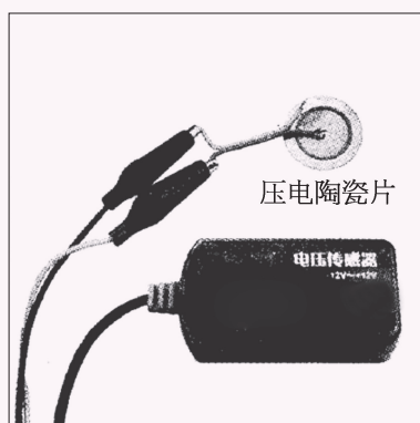
图 9-18 压电陶瓷片连接电压传感器
