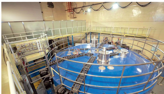
图 5-35 我国 100 MeV 回旋加速器
