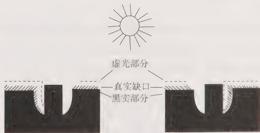
图 7-28 缺口部分产生虚光，形成三层缺口
